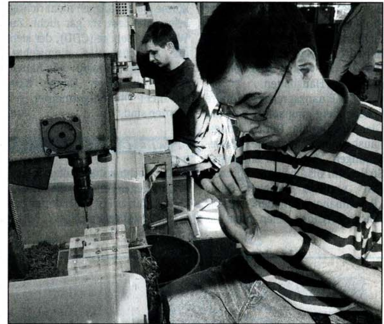
Sensible Finger braucht Stephan Hofmann, Mitarbeiter in den Werkstätten für Behinderte, bei den Präzisionsbohrungen für Plexiglas-Chips.
